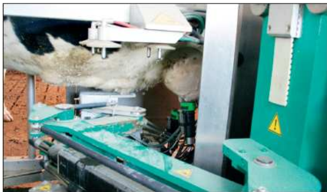
Díky využití technologie 3D kamery nasazuje robot násadce na struky spolehlivě
