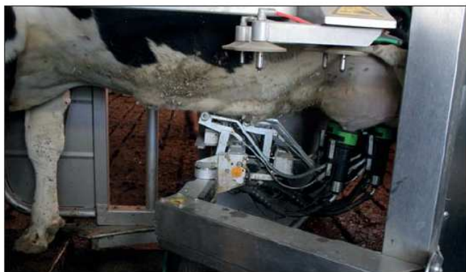
Pro rychlé nasazení strukových násadců robot Mlone využívá technologii 3D kamery Foto Alena Ježková
