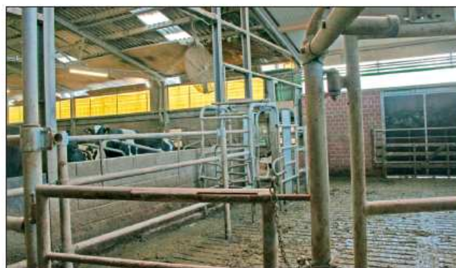
Předselektivní branka pouští k robotu jen ty dojnice, které se mají dojit
