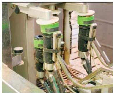
Po každém dojení se automaticky proplachují strukové násadce
