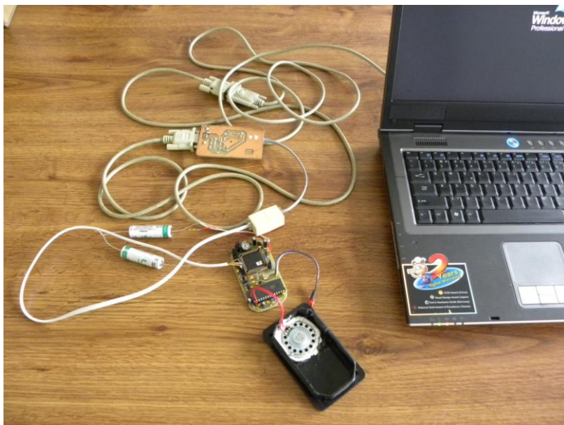
Obr. 8 Připojení audiostimulátoru přes telefonní kabel a převodník k počítači
