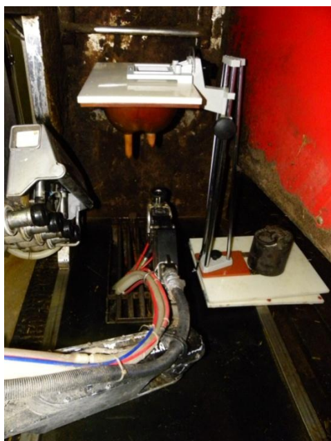
Obr. 27 - Ověřování možnosti využití polohovatelného stojanu s umělým vemenem pro měření rychlosti nasazování strukových násadců u dojícího robotu Galaxy na farmě Slatina nad Úpou
