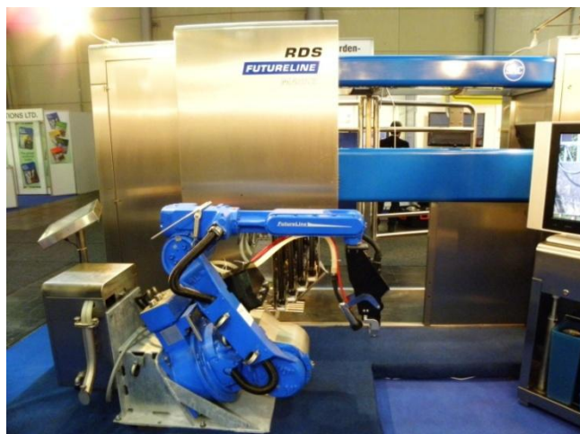
Obr. 14 - Dojící robot RDS – FutureLine firmy SAC Christensen
