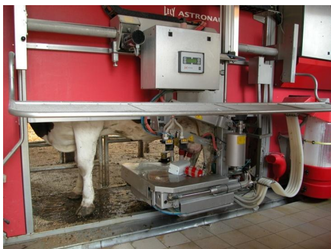
Obr. 8 - Dojící robot Lely Astronaut na farmě v Pacově
