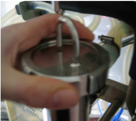
1. Odšroubujte pojistné víko a vytáhněte ho.
