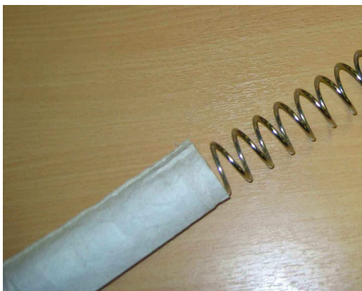
5. Na filtr navlečte NOVOU vložku.
