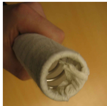
6. Přebytečnou část vložky filtru ohněte dovnitř.
