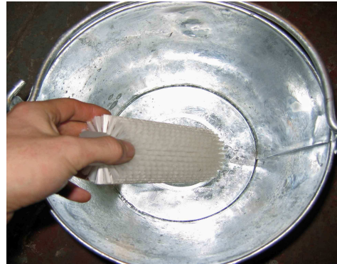
7. Kartáče důkladně vyčistěte, měli byste to udělat s použitím dezinfekce a horké vody, důkladně opláchněte. Použité chemikálie viz oddíl 13.3 .
