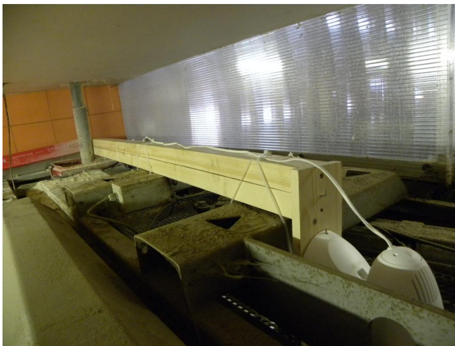
Obr. 1 – Umístění infrazářiče v dojícím robotu Lely Astronaut
